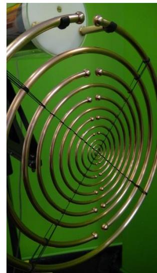
Die RK17 Antenne entspricht weniger genau den Originalantennen hinsichtlich der Ringmasse. Die RKM5 und RKMH5 Geräte entsprechen den Originalen Antennen, aus Aluminium sehr genau. Bei RT17 ist dies leider nicht der Fall. Kupfer ist aber besser als Aluminium und ist vorzuziehen.
