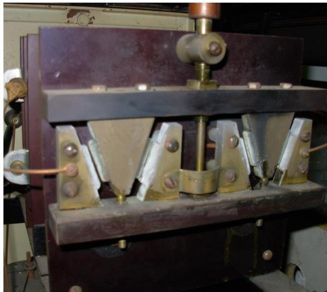
Das RT17 Gerät hat eine zusätzliche Funkenstrecke, die einen Coronabetrieb verhindert, da bei RT17 die Spulen beschädigt würden. Bei den RKM5 und RKMH5 ist der Coronabetrieb möglich, da die Spulen auf Krülitrohr gewickelt sind, welches als Isolationsmaterial für hohe Temperaturen entwickelt wurde.
