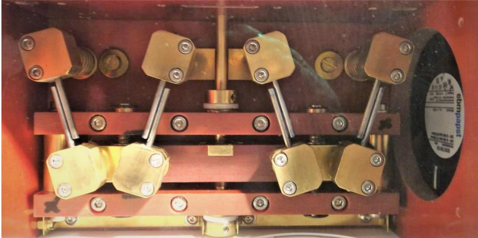
Bei RT17 gestaltet sich die Reinigung und Wartung der sehr gut gebauten Funkenstrecke als aufwendig. Die dicke der Wolframstäbe ist originalgetreu. Bei den RKM5 und RKMH5 Geräten sind die Wolframstäbe dicker und die Funkenstrecke ist einfach zu reinigen. Die Funkenstrecke ist eine klassische V-Funkenstrecke. Unten links eine original Funkenstrecke.
